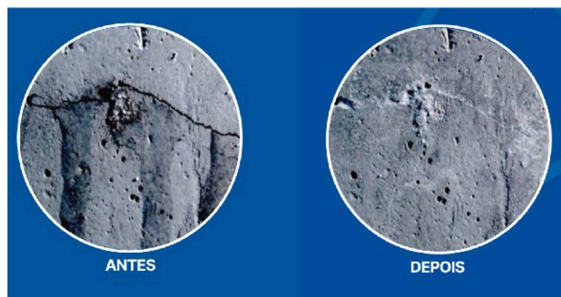
Teste de autocicatrização: Procedimento mexicano baseado no GB 18445/1
